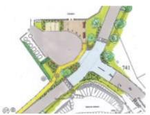
Esquisse n° 3 : Chaussée déportée pour casser l'effet « ligne droite » à l'arrivée dans l'agglomération, mise en place d'un STOP pour les véhicules arrivant dans l'agglomération, et création de 7 stationnements pour le cimetière.
