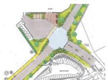
Esquisse n°2: Chaussée légèrement déportée (3.00ml) pour créer un effet « chicane », chaussée surélevée au niveau du carrefour RD 20/rue du Fourneau et aménagement du parvis du cimetière avec création de 3 stationnements.
